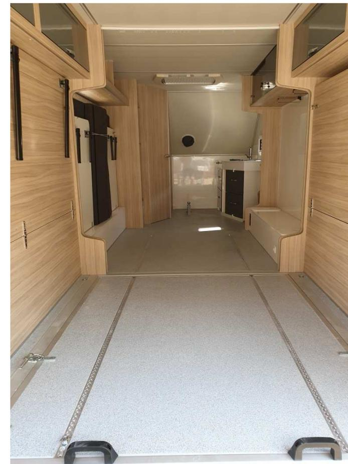
Im Innenraum werden die Betten und die Sitzgruppe mit wenigen Handgriffen hochgeklappt. Zum Verladen wird die große Heckklappe gasfederunterstützt geöffnet. Anschließend wird der Boden im Heckbereich entriegelt und abgesenkt. Dieser dient dann als Auffahrrampe.
